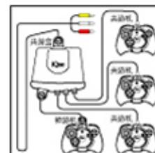
《任天堂明星大乱斗》支持多人游戏。你必须有共游盒和共游机才能玩多人游戏。请依照左图将神游机、共游机与共游盒连接。再将共游盒与电视机连接，连接方式和神游机与电视机的连接方式相同。
